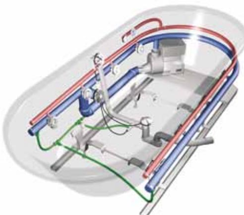
Modro označené potrubie rozvádzia vodu od čerpadla do trysiek. Červeno označené potrubie je určené pre rozvod pasívne primiešavaného vzduchu. Spád potrubia zaistuje po otvorení odpadovej armatúry úplné vyprázdnenie zostatkovej vody z vírivého systému. Tým sú splnené najvyššie hygienické normy (RAL-GZ 704).
