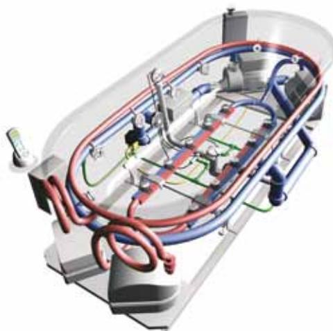
S dvomi čerpadlami a dvomi dúchadlami disponuje systém najvyšším výkonom. Modro označeným potrubím sa do vane vháňa voda, červeným vzduch. Sklon potrubia zaistuje po otvorení odpadovej armatúry kompletne vyprázdnenie zostatkovej vody. Dezinfekciu modrého potrubia privádzajúceho vodu zaistuje polautomatické dezinfekčné zariadenie. Červené vzduchové potrubie sa po kúpeľi automaticky vysuší. Tým sú splnené najvyššie hygienické normy (RAL-GZ 704).
