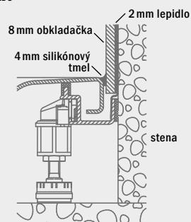
Pri použití obkladačiek v hrúbke 10 mm + 2 mm lepidla bude škára medzi sprchovacou vaničkou a obkladačkou 2 mm. V prípade hrubších obkladačiek je nutné osadiť rám ESR II od steny, aby vznikla dostatočná medzera.
