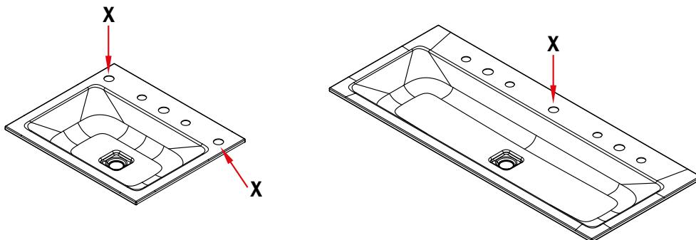
x - možné polohy otvoru pre ovládač CLOU odpadovej a prepadovej súpravy 3902 / 3903 a 3910 / 3911
