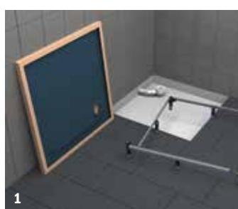
Pokiaľ je to nutné, skráťte spojovacie profily na správny rozmer. Zostavte inštalačný rám. Nastavte nožičky na požadovanú montážnu výšku a naskrutkujte ich do rohových spojok a vodiacich vložiek.
